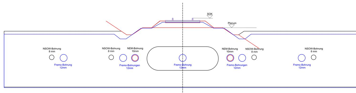
NEM-Profil über das NSOW-Profil und über das Fremo-Profil gelegt zeigt kleine Unterschiede im Oberbau bedingt durch das Schienenprofil. Hier gibt es einen Unterschied von weniger als 1mm in der Höhe
